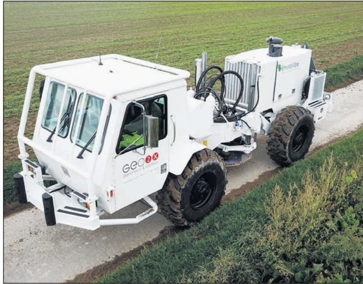
Mit einem speziellen Vibrationsfahrzeug werden Schallwellen erzeugt, drahtlose Messinstrumente zeichnen die seismischen Wellen anschliessend auf.
