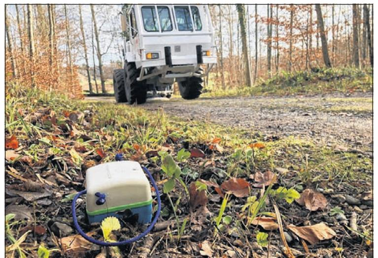
Mit dem Vibrotruck werden oberflächlich Schwingungen ausgelöst, die von einem Seismographen aufgezeichnet werden.
