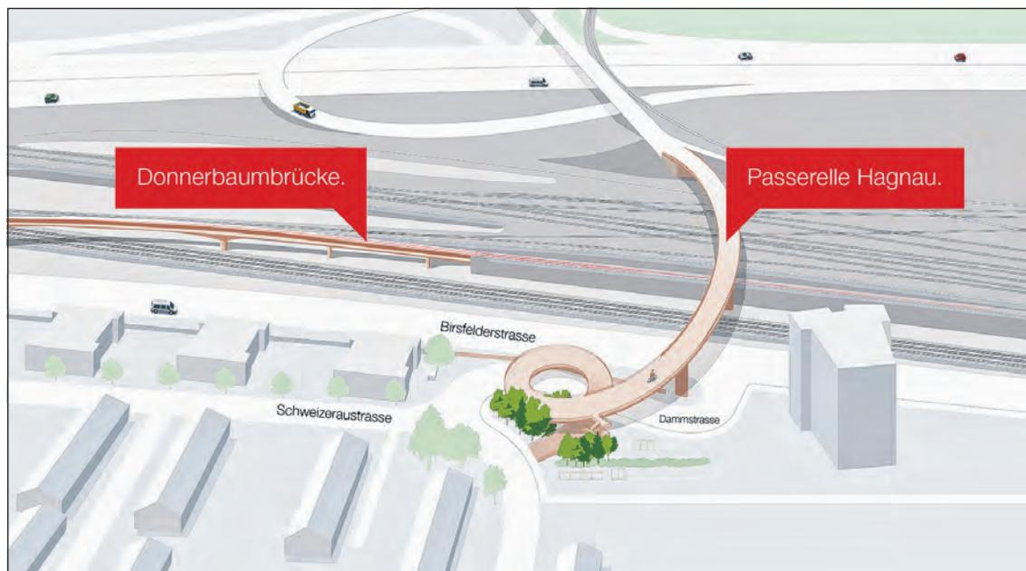
Beim Donnerbaumquartier wird eine einspurige Brücke geplant, welche über die drei bestehenden Spuren führen wird. Östlich davon wird eine Passerelle für den Velo- und Fussverkehr die Gleise überspannen.
