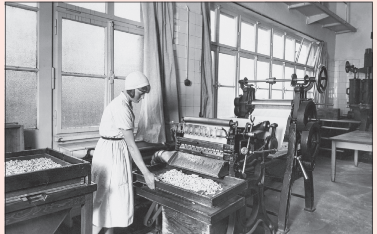
Herstellung Teigmüscheli: Ausstechmaschine um 1925.
