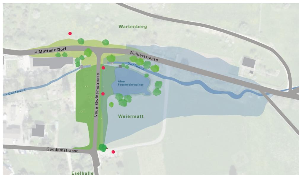
Links: Die Lage des Hochwasserschutzdamms (neue Gwidemstrasse), des Rückhaltebeckens und der möglichen vier Standorte für Sondierbohrungen.
