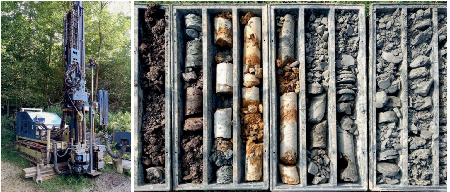
Bei Sondierbohrungen wird ein Rohr in die Tiefe getrieben, das sich durch die abgelagerten Boden- und Gesteinsschichten arbeitet und diese als zylindrische Körper entnimmt. Die Bohrkerns bieten einen präzisen, detaillierten Einblick in die Struktur des Untergrunds und werden in einer Bohrkiste gelagert.
