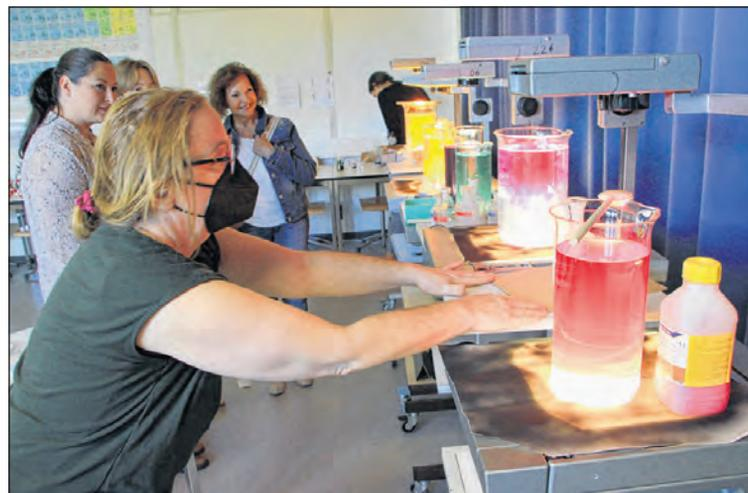
Die Farbumschläge eines Indikators: Phenolphthalein-Lösung macht die Chemie bunt.
