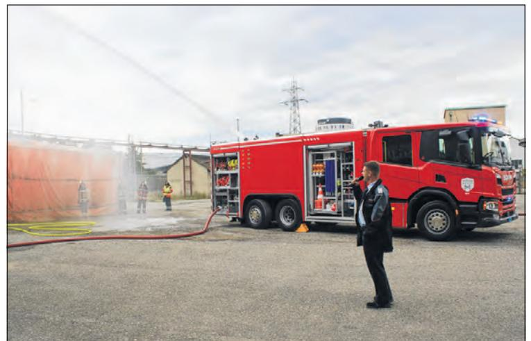
Der über Funk zu steuernde Wasserwerfer kann seinen Strahl über eine Distanz von 70 Metern niedergehen lassen.
