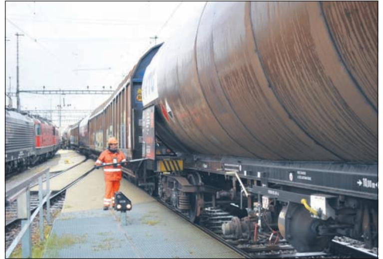
Ein Bahnarbeiter trennt zwei Waggons mithilfe eines Metallstocks. Er überwacht danach den gesamten Rangierbetrieb mit grosser Vorsicht.
